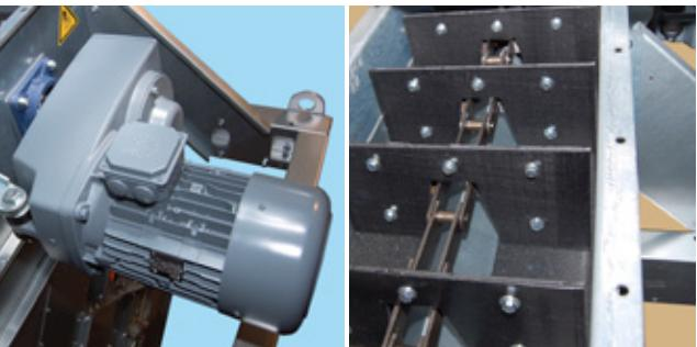
Напрямую смонтированный мотор-редуктор с опорной рамой.
